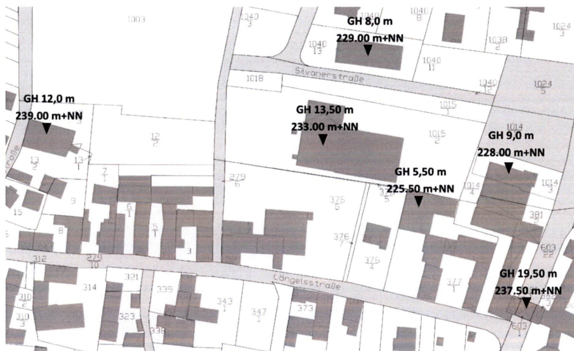
Bild 15: Übersicht der Höhen des Gebäudebestandes in der näheren Umgebung
